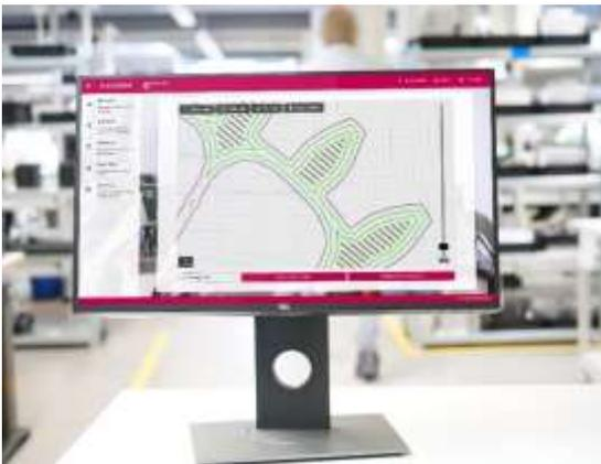
Die additive Fertigung (AM) und insbesondere metallische AM streben nach höherem Durchsatz und weniger Ausschuss. Die Datenvorbereitung ist entscheidend, um die Produktivität zu steigern und die Prozessentwicklungszeiten zu verkürzen. Das Steuerungssystem SCANmotionControl ermöglicht es Prozessentwicklern, die Scanpfade der Laser offline auf dem PC zu simulieren. Da
